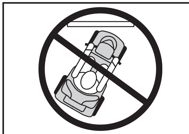
Abb. 3A. Falsches Anfahren einer Bordsteinkante
