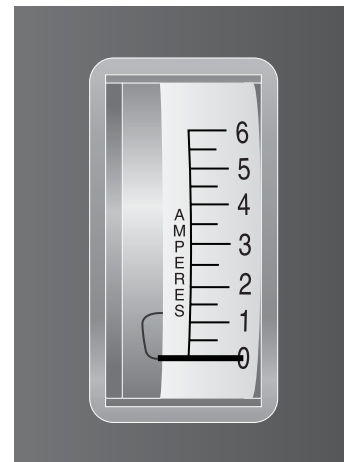
Abb. 8. Amperemeter (zeigt Vollgeladene Batterien an)
